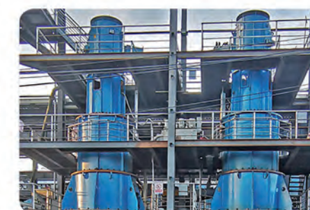
1250kW 立磨机 1250kW vertical grinding mill
